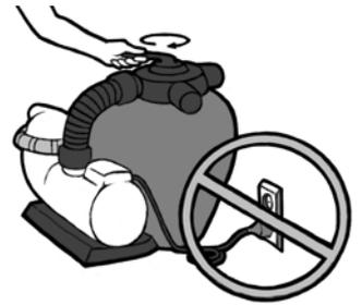
**Jos käytät hiekkaa suodattamiseen, tulee suodatusmassa pestä ensimmäisellä käyttökerralla seuraavasti:**
