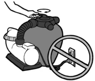
**Si vous utilisez du sable pour le filtrage, la masse filtrante doit être lavée au moment de la première utilisation de la manière suivante :**
