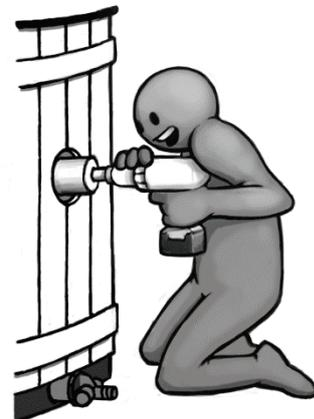
Fixer le passe-cloison au plastique de manière à ce que la lèvre du joint se trouve des deux côtés du bassin en plastique et serrer fortement le passe-cloison.
