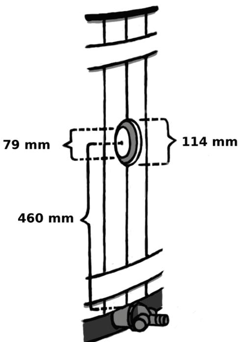
I en Kirami plasttunna är det mycket enkelt att montera en genomföringssats, man behöver bara borra hål för en genomföring. I själva plasten borras ett Ø79 mm hål och på motsvarande ställe i träpanelen ett >Ø114 mm hål. Hålet i panelen ska vara större, för att man ska kunna dra åt genomföringen och ha rum att vrida delarna på plats.
