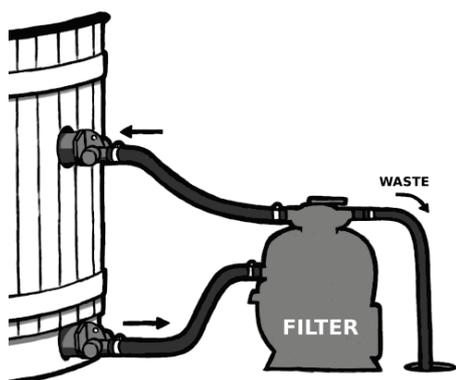
На зиму или при снятии фильтра в целом выходное отверстие следует закрывать поставляемой в комплекте крышкой/заглушками. Когда купель не используется, из сливного клапана следует удалить заглушку, которой он оснащен. Это необходимо для исключения риска застревания заглушки в каркасе клапана. При заморозках, даже если купель пустая, клапаны (в более старых купелях) следует оставлять наполовину открытыми во избежание их повреждения остатками заледеневшей воды.
