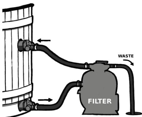
kokonaan pois kun tynnyriä ei käytetä, näin vältetään tulpan mahdollinen jumittuminen venttiilin runkoon. Kylmällä säällä tyhjänkin altaan venttiilit (vanhemmissa tynnyreissä) tulee jättää puoliksi auki, jotta niihin jäänyt vesi ei pääse jäätyessään rikkomaan venttiilejä.
