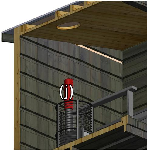
**1.** Befestigen Sie das unisolierte Abgasrohr (j) am Saunaofen.
