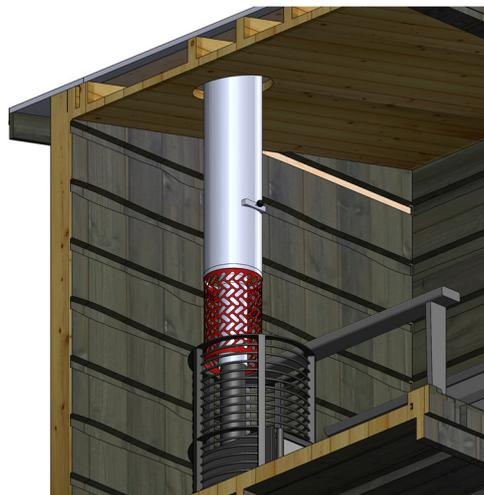
**4.** Bringen Sie den Steinkorb um das Verbindungsrohr an und füllen Sie ihn mit kleineren Steinen.
