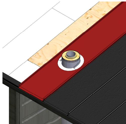
**11.** Installieren Sie das Dachblech.
