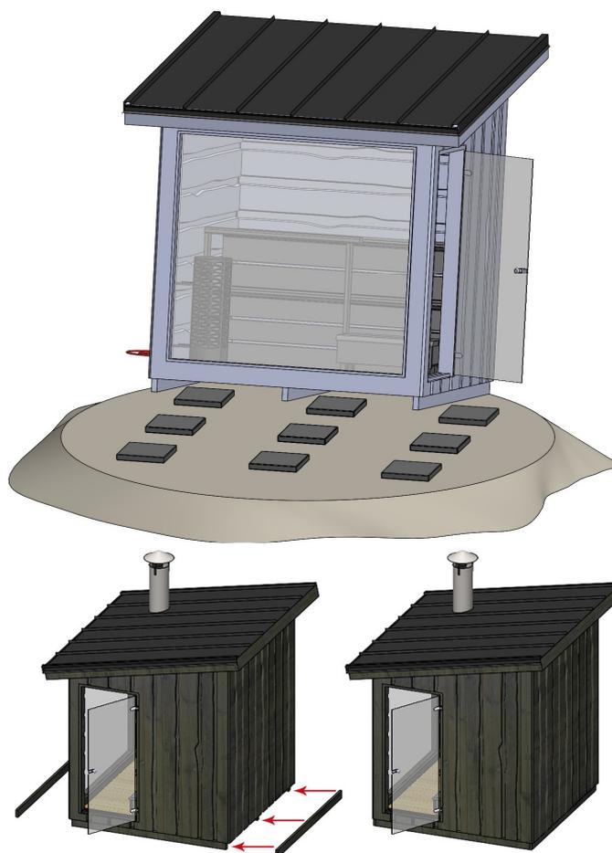
Wenn die Sauna auf ihren endgültigen Bestimmungsort herabgelassen und die Geradlinigkeit mit einer Wasserwaage überprüft worden ist, sind abschließend die vorderen und hinteren **Deckleisten für Unterbalken (20)** mit **Terrassenschrauben (5)** zu befestigen.
