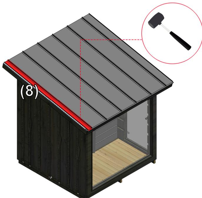
12. Befestigen Sie das schmale Dachblech „Abschluß“ (8), wenn benötigt mit Gummihammer.
