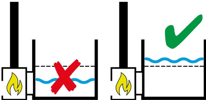
Bevor Sie mit dem Aufheizen beginnen, befüllen Sie das Badefass bitte bis zum Mindestfüllstand mit Wasser.
