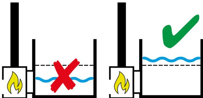
Remplissez le bain jusqu'au niveau de remplissage minimum, c'est-à-dire 5 cm au-dessus du passe-paroi supérieur du poêle, avant de commencer à chauffer.
