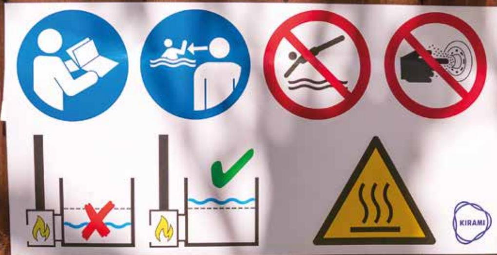
Befüllen Sie das Badefass bis zum Mindestfüllstand mit Wasser, d.h. ca. 5 cm über dem oberen Rohr des Ofens, bevor Sie mit dem Aufheizen beginnen.
