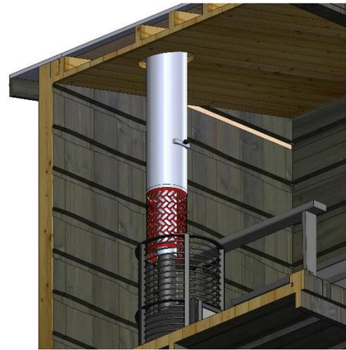
**4.** Установите емкость для камней таким образом, чтобы неизолированная соединительная труба оказалась внутри
