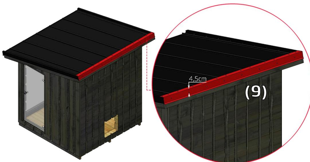
**17.** В завершение установите торцевую планку на верхнем торце кровли (9) с помощью кровельных саморезов (16).
