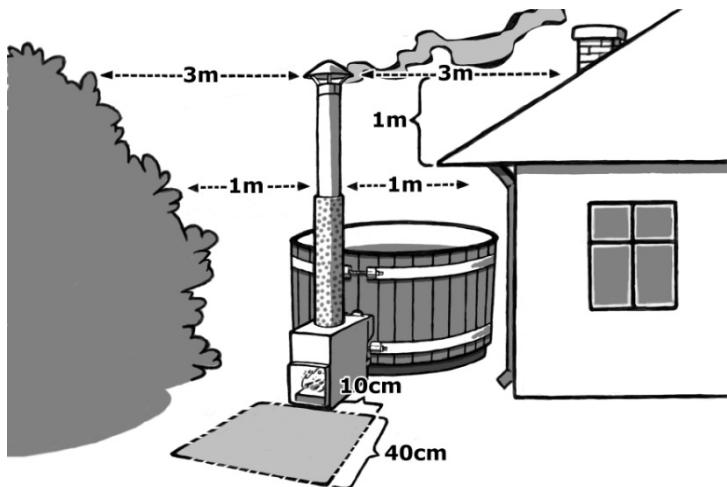
Если купель устанавливается недалеко от домов и построек, например, на краю террасы, необходимо проверить, чтобы дымоход был на противопожарном расстоянии от всех построек и конструкций из легко возгораемых материалов. Расстояние должно быть достаточным как по горизонтали, так и по вертикали, чтобы избежать риска возгорания. В горизонтальном направлении от устья трубы дымохода до легко возгораемых материалов должно быть не менее 3 метров. Другие части трубы могут находиться и на
