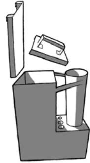
SIDE, CUBE och TUBE kaminernas eldstad har två stycken rostar och ett kompakt L-järn. De placeras på stöden i kaminen som bilden visar. L-järnet placeras med den vikta kanten uppåt i främre delen av eldstaden, på så vis styr det luftflödet och håller samtidigt veden bättre på plats. Dessa ska vara på plats alltid då man använder kaminen. (Bilden till höger)
