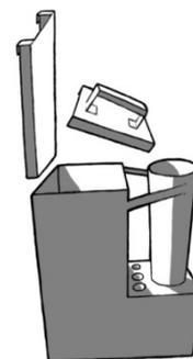
Deux grilles à tuyère et une plaque de fer en L fermée doivent être placées dans le foyer des poêles SIDE, CUBE et TUBE. Elles se placent sur les supports du poêle comme indiqué sur l'image. La plaque de fer en L se place en haut, sur le bord replié avant du foyer afin de diriger l'air et mieux maintenir les bûches dans le foyer. Les bûches doivent toujours se trouver à leur place lorsque vous utilisez le poêle. (Image de droite)
