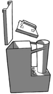
De SIDE, CUBE en TUBE kachels worden geleverd met twee roosters en een stevige L-vormige metalen plaat. Deze worden in de kachel geïnstalleerd op de daarvoor bestemde dragers zoals aangegeven in de afbeelding. De rand van de L-vormige plaat dient naar boven te wijzen, zodat deze het brandhout beter op zijn plaats houdt. Deze onderdelen dienen bij gebruik van de kachel altijd te zijn geplaatst. (Zie afbeelding rechts)
