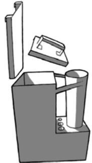
In die Feuerstelle der Öfen SIDE, CUBE und TUBE kommen zwei Gitterroste und ein geschlossenes L-Eisen. Sie werden wie in der Abbildung auf die Träger im Ofen gelegt. Das L-Eisen wird als vorderstes Teil mit dem gebogenen Rand nach oben gelegt. So fungiert es als Luftführung und hält das Brennholz besser im Ofen. Sie müssen sich beim Heizen immer im Ofen befinden (Abb. rechts).
