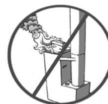
направлении, т.е. чтобы дым и пламя не вырвались из дверцы топки. Направление тяги можно отрегулировать, подув в зазор между крышкой и воздушной заслонкой, или поджечь небольшую щепку или кусочек другого растопочного материала в верхней части дымовой трубы. Устье печи и дверца могут деформироваться, если тяга будет все время идти в неправильном направлении, в этом случае гарантия действовать не будет.
