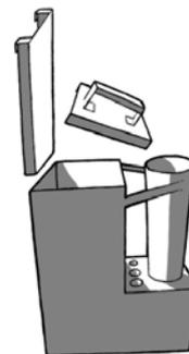
В печах типа SIDE, CUBE и TUBE в топке расположено две колосниковые решётки и одна сплошная L-образная плита. Они устанавливаются внутрь печи на специальные опоры, как показано на рисунке. L-образная плита, расположенная ближе всех к краю топки, своим загнутым краем направляет воздушный поток, а также помогает наилучшим образом распределить дрова внутри топки. Следите за тем, чтобы при эксплуатации печи решётки всегда были на месте (см. рисунок справа).
