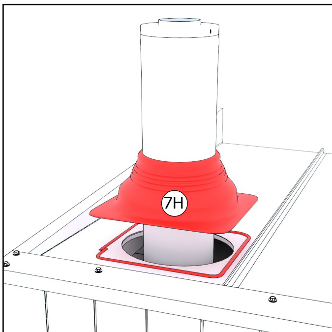
15. Pujota piipun yläkautta sadekaulus ja painele se huolella silikonin päälle kiinni peltikattoon. Ylipursunut silikonit tasoitetaan kauluksen reunaa vasten.
