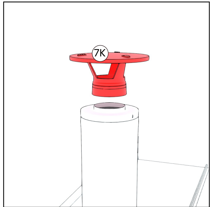
18. Lås regnkragen på plats genom att vrida den lätt medurs.
